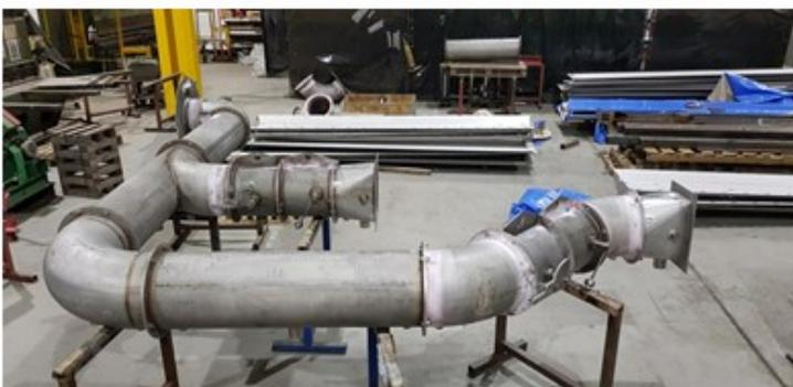
Damper Derivador em "T" acionamento Pneumático com sistema de braço articulado
